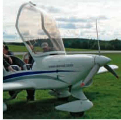
Den trebladiga propellern är "aero-elastisk", d v s vrider sig något vid belastning och skapar gynnsam stigning. Justerbar på marken för olika flyguppdrag.
