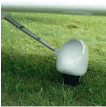
Den trebladiga propellern är "aero-elastisk", d v s vrider sig något vid belastning och skapar gynnsam stigning. Justerbar på marken för olika flyguppdrag.
